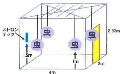
28m<sup>2</sup>の部屋においてストロンテックをスイッチⅢ (3分間に25秒間欠噴霧)で稼働させ、床面から1mの高さに供試昆虫をメッシュボールに入れて配置しました。
